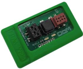
El **CCM-WIFI** es uno de los dispositivos de la familia **CCM**, pensado para conectarse a los dispositivos principales (**CCM2** y **CCM4**) dotarlos de conectividad inalámbrica. Este dispositivo, como todos los dataloggers WiFi, permite mantener la comunicación Modbus entre los **CCM** principales, respetando la conexión cableada entre el **CCM** principal que lo aloja y los **CCM** secundarios conectados al bus secundario en cuestión.
