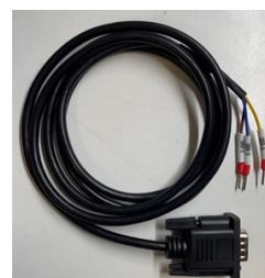
Figura 7 Cable DB9 macho acabado en conector
